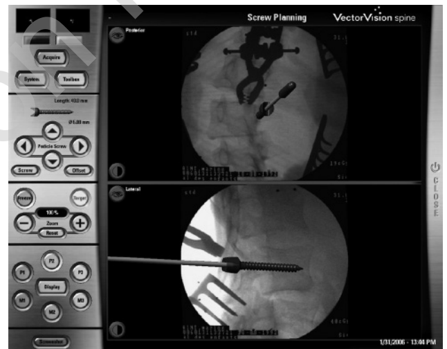
Fig. 4. Navigation. Les instruments sont calibrés et repérés par les caméras. Le contrôle de la position des instruments est effectué sur l'écran. Ici implantation d'une vis pédiculaire.
